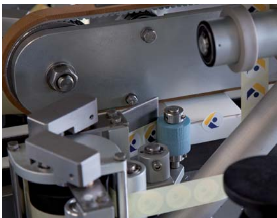
Dispositivo stabilizzatore prodotto in fase di etichettatura sigilli Device to stabilize the products during the tamper-evident labelling phase
