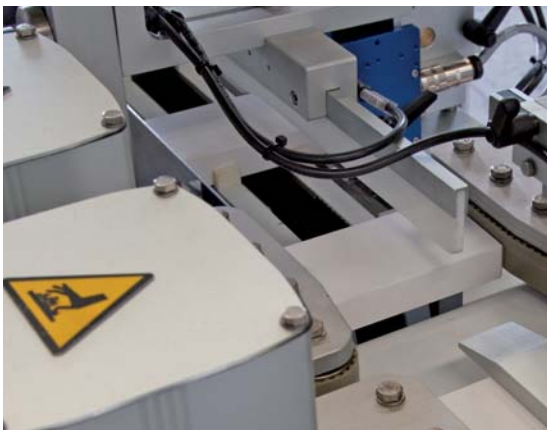
Doppio nastro di trasporto a cinghia dentata con spintori a trasporto positivo Couple of parallel toothed belts conveyor with positive pushers
